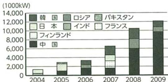
図8 国別の新規着工原子炉の発電容量 (2004-2009) 出典:IAEA-PRIS
