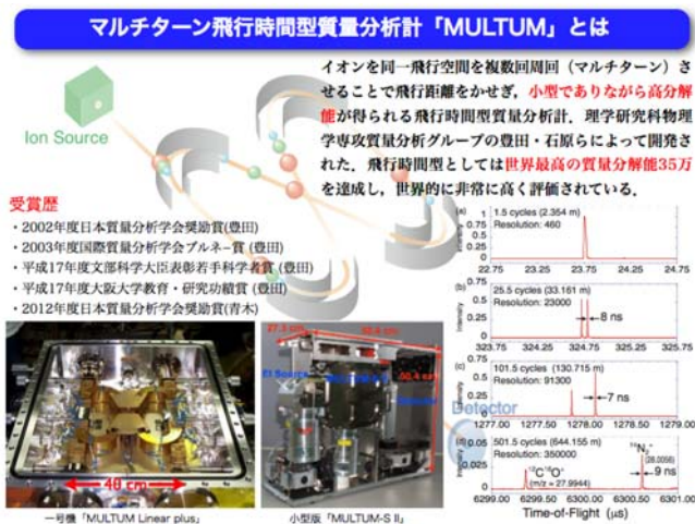
図7 豊田らが世界に先駆けて開発した、マルチターン飛行時間型質量分析計 (MULTUM)。デスクトップコンピューター程度の大きさでしかないが、超高分解能質量分析計である FT-ICR-MS に匹敵する 3-10 万の質量分解能を持つ。現在、この MULTUM だけがフィールドに持ち出せる唯一の超高分解能質量分析計である。
