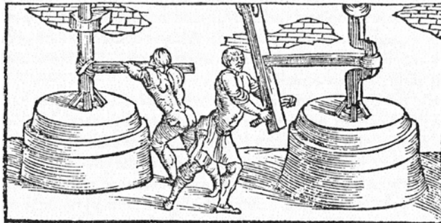
図 4 中世ヨーロッパにおける石臼粉碎機を利用したアマルガム化
